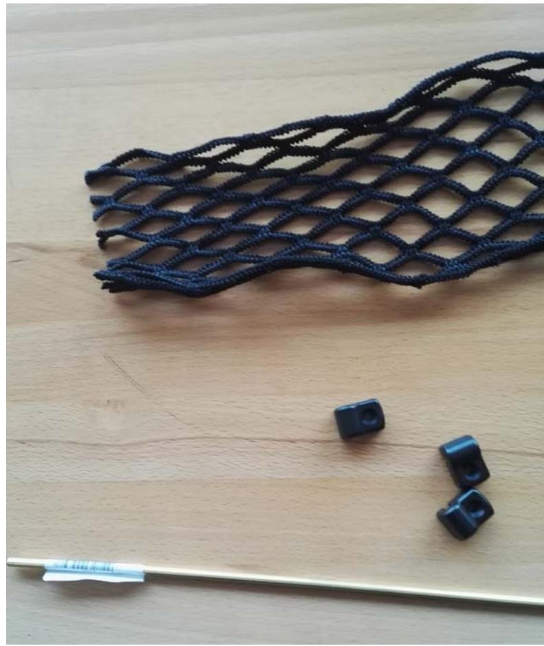
A) Netzrahmen hinten: Ungefähres Biegemuster (1:1) s. Anhang. 4 mm Draht grob biegen und Passform testen. Dann mit Schrumpfschlauch überziehen und das Netz auffädeln.
